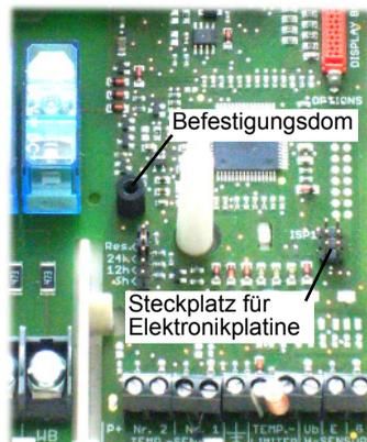
Stecken Sie die Elektronikplatine mit der Anschlussbuchse auf den vorgesehenen Steckplatz.
