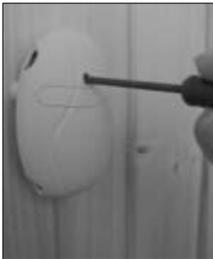
Figure 35. Bouton de réinitialisation du circuit de surchauffe
