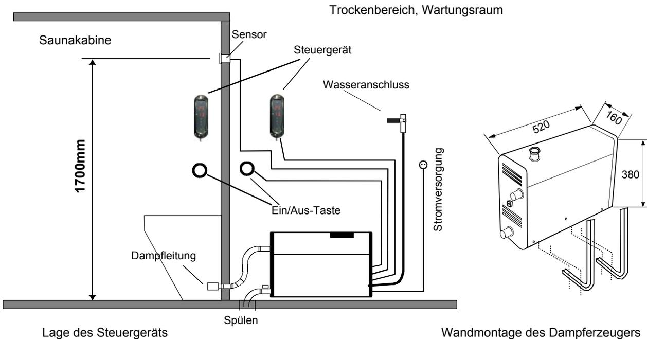
Beim Modell HNS - M2 wird das **Steuergerät** in der Saunakabine oder außerhalb installiert.
