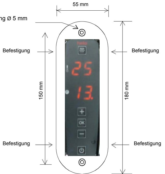
Der Rahmen des Steuergerätes wird direkt darauf gedrückt. Das Abziehen erfolgt mit einem Werkzeug, das mit dem Gerät mitgeliepert wird. Der Rahmen hat kleine Öffnungen an den Kanten. (4 Öffnungen) Den Sicherungsstift mit dem Werkzeug leicht durch die Öffnung drücken, einen nach dem anderen und gleichzeitig den Rahmen nach außen ziehen.
