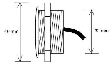
Der Sensor wird in einer Höhe von 170 cm installiert, vorzugsweise auf der Seite, die der Tür gegenüber liegt. Bei Acrylwänden kann eine Haltemutter verwendet werden. Bei einer dickeren Wand kann auch ein Loch gebohrt werden, das allerdings mit einem geeigneten Dichtungsmittel versiegelt werden muss, um das Eindringen von Feuchtigkeit in die Bausubstanz zu verhindern. Setzen Sie den Sensor in das Gehäuse ein und befestigen Sie das Kabel mit einer Klemmschraube.
