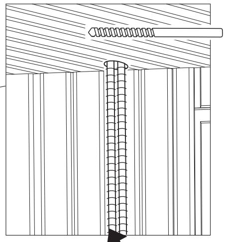
Värmebeständig kabel (170°C)
