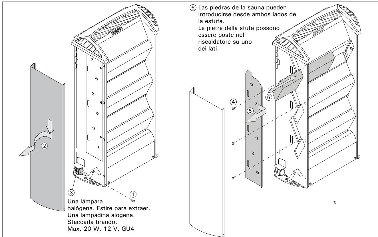
**Figura 1. Cambio de la bombilla de la estufa e colocacion de las piedras de la sauna**
