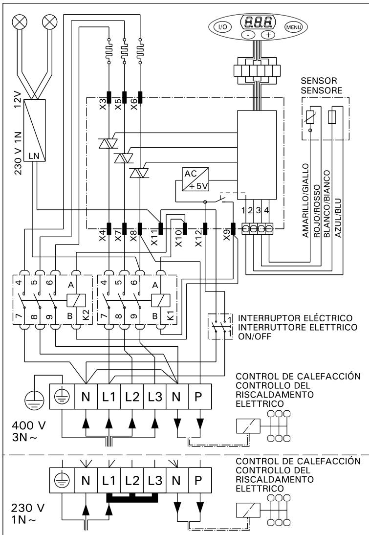
**Figura 10. Conexiones eléctricas de los calentadores FU**
