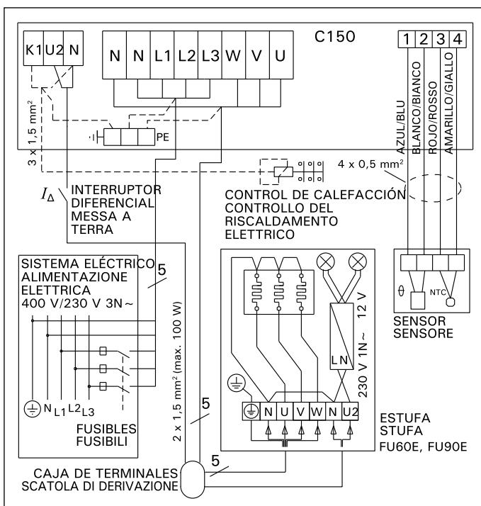
**Figura 12a. Conexiones eléctricas para estufa FU-E, y para el centro de control C150 (3-fase)**
