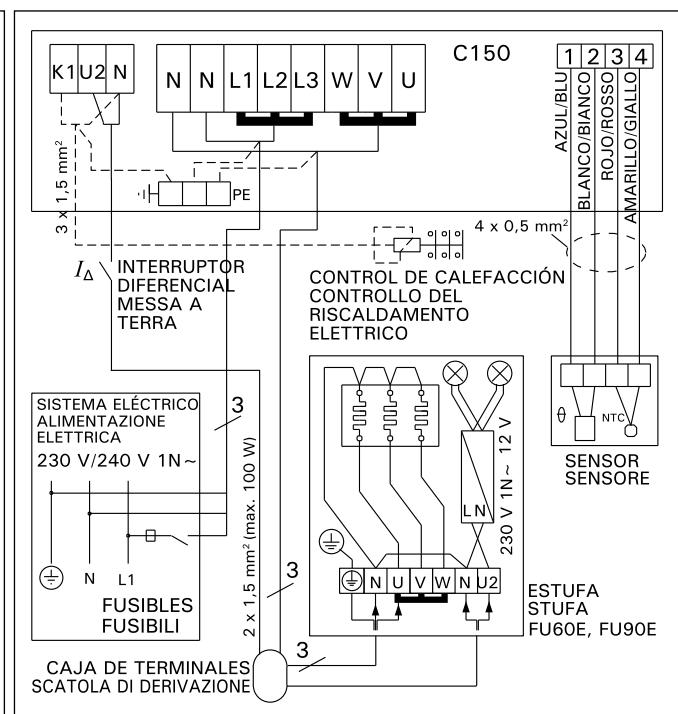
**Figura 12b. Conexiones eléctricas para estufa FU-E, y para el centro de control C150 (una fase)**
