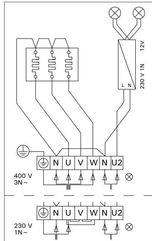
**Figura 11. Conexiones eléctricas de los calentadores FU-E**
