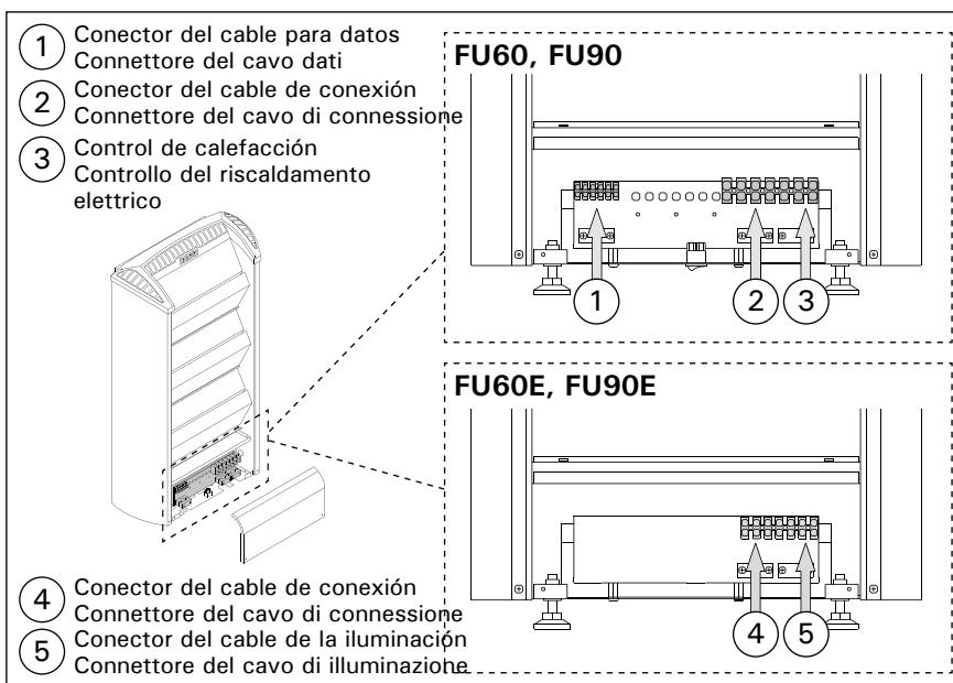
**Figura 7. Unidades de control para el calentador**
