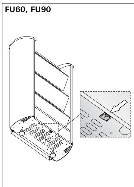
**Figura 8. Interruptor eléctrico ON/OFF**
