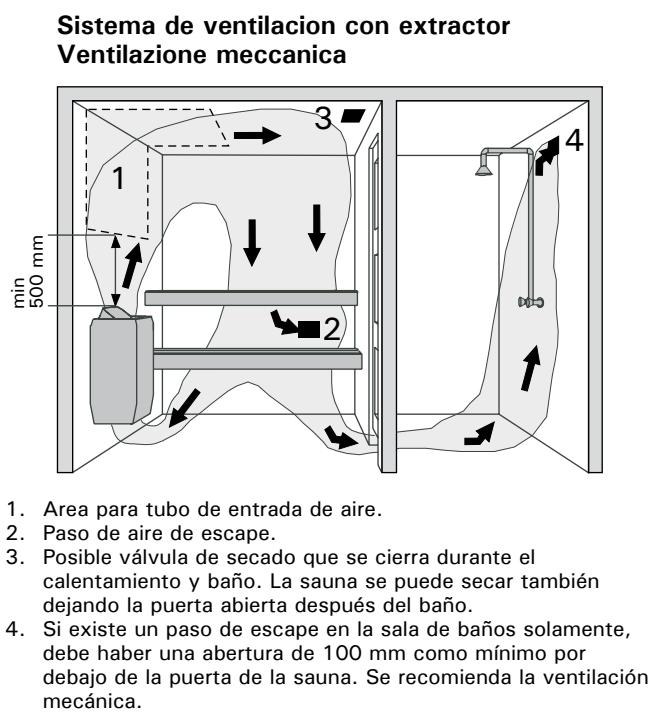
Figura 4. Ventilación de la sauna
