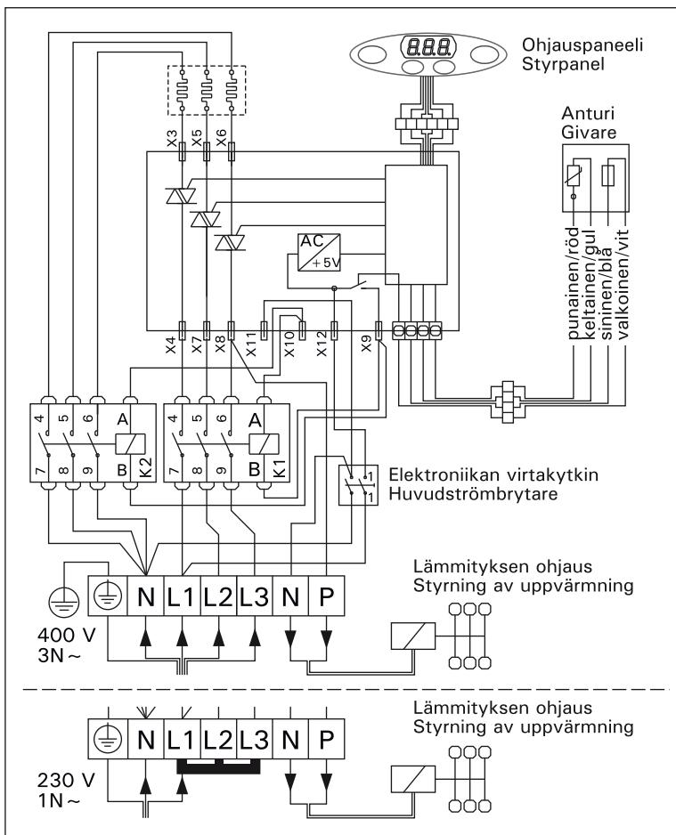
Kuva 8. PI-kiukaan sähkökytkennät
