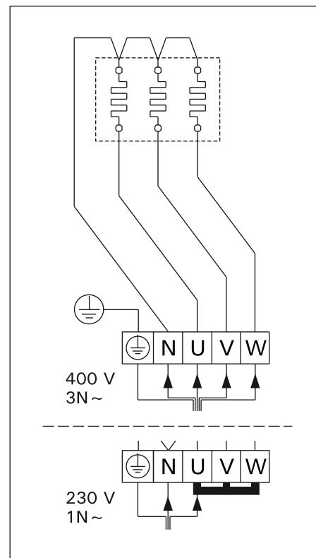
Kuva 9. PI-kiukaan sähkökytkennät
