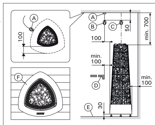
**Kuva 6. Suojaetäisyys (mitat millimetreinä)
