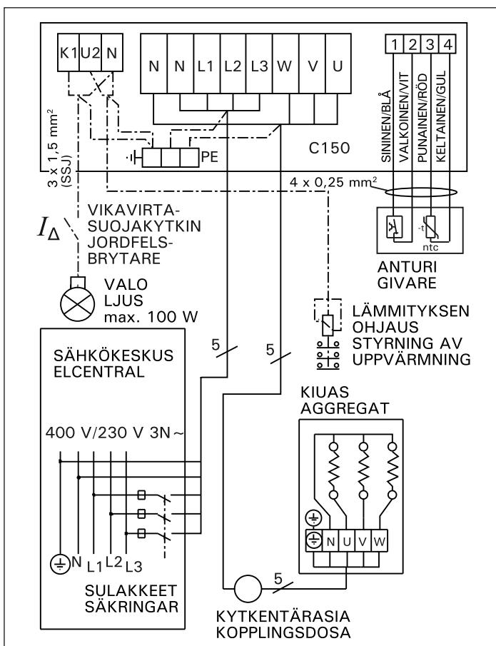
Kuva 10. Ohjauskeskuksen C150 ja PI-kiukaan sähkökytkennät
