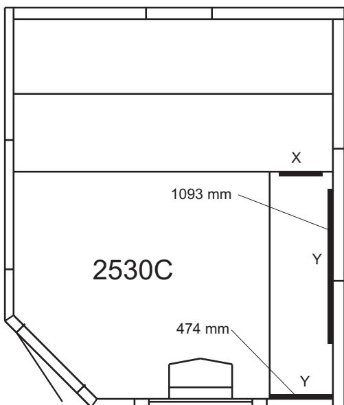
Skruta fast X-regeln på den nedre laven och Y-reglarna mot vägg. Lägg på den färdigmonterade laven.
