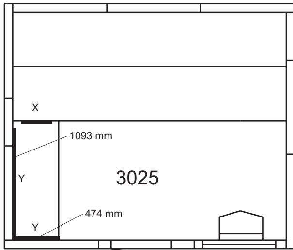
Skruta fast X-reglar på övre och nedre laven. Kapa den ena 1093-regeln enligt skiss. Skruva fast de övre Y-reglarna 830 mm från golv och den kapade regeln 380 mm från golv. Lägg på de färdigmonterade lavarna.
