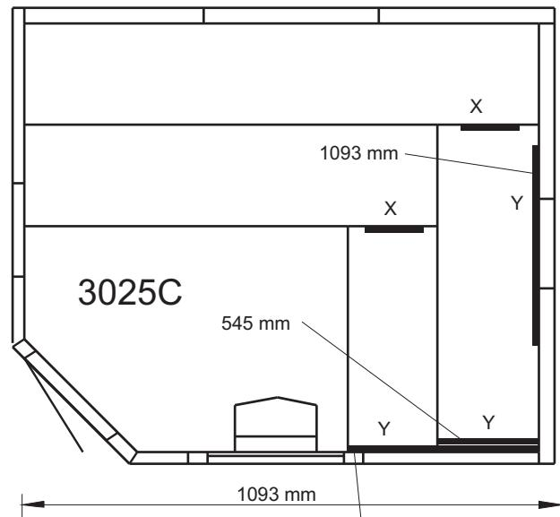
Atornillar las reglas X en los bancos superior e inferior. Cortar una regla 1093 según diagrama. Atornillar las reglas superiores Y a 830 mm del suelo y la regla cortada a 380 mm del suelo. Colocar los bancos ya montados.
