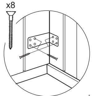
Skruta fast X-reglarna på den nedre laven och Y-reglarna mot vägg. Montera armstödet. Lägg på de färdigmonterade lavarna.
