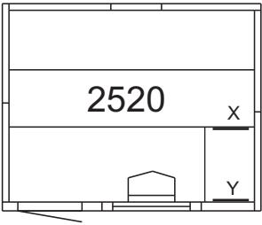
Skruta fast 350 mm-regeln (X) på den nedre laven och Y-regeln mot väggen. Montera armstödet (2025/2025C).
