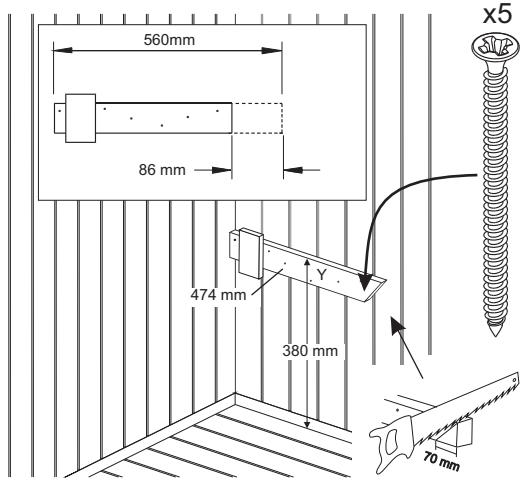
Den 350 mm-Riegel an der unteren Pritsche und den Y-Riegel an der Wand festschrauben. Armlehne montieren (2025/2025C).
