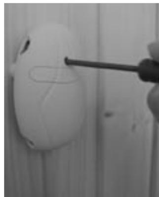
Abbildung 15. Rücksetzknopf des Überhitzungsschutzes.
