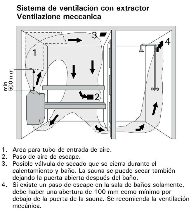
Figura 4. Ventilación de la sauna
