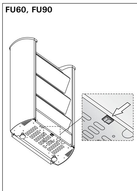
**Figura 8. Interruptor eléctrico ON/OFF**
