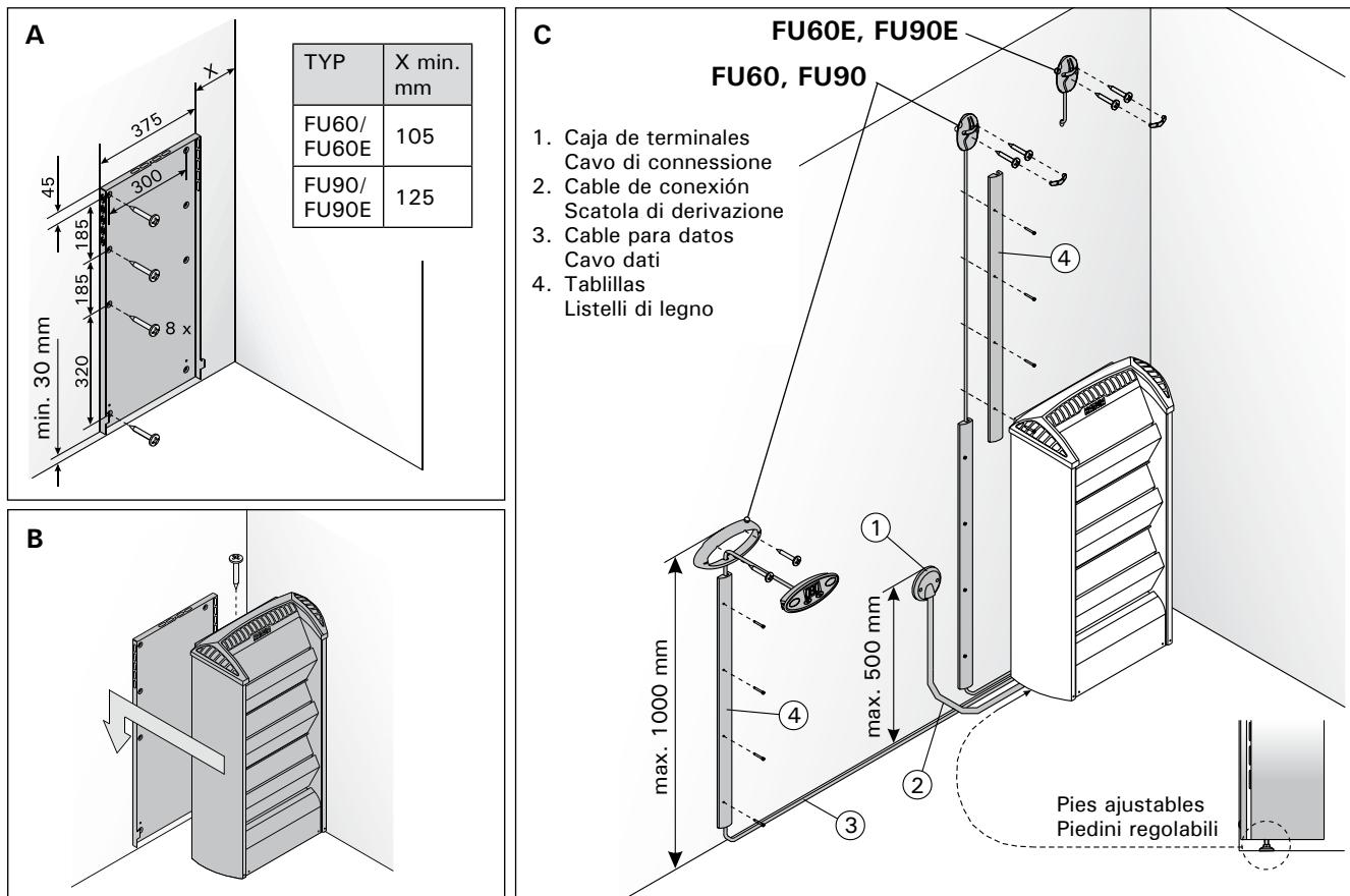
Figura 9. Ubicación de la estantería de sujeción y conexión de la estufa
