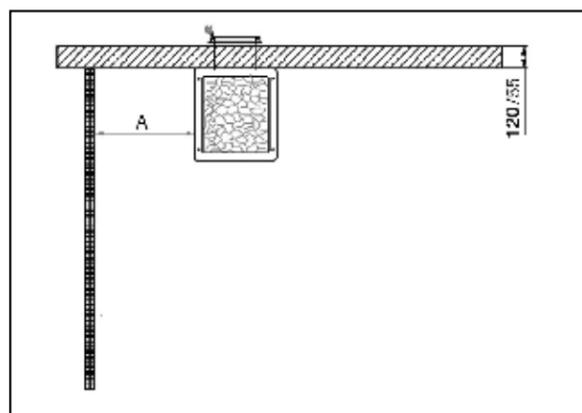
Maß A wird gemäß der bei Holzoberflächen verwendeten Schutzmethode gewählt.
