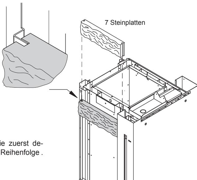
Abschliessend montieren Sie die zuerst demontierten Teile in umgekehrter Reihenfolge.
