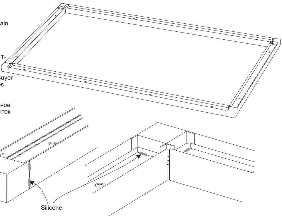
**4** Placera golvramen där rummet ska stå. Kontrollera att ramen ligger plant, använd vattenpass. OBS! Det är ett absolut krav att golvramen ligger plant "i väg" för att slutresultatet ska bli perfekt. Justera ställfötterna med insexnyckeln. Det är viktigt att ställfoten hamnar under ytan där väggarna ska stå.
