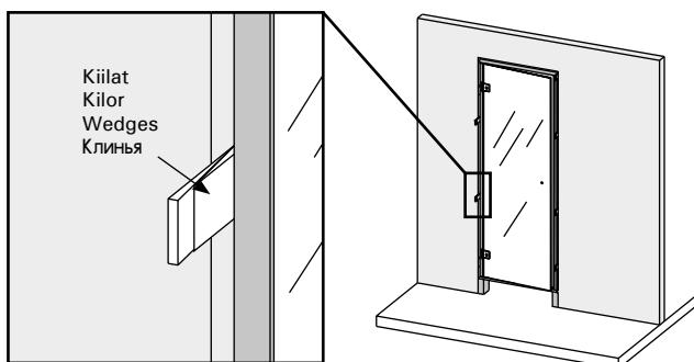
**6.** Kun karmit on kiinnitetty ruuveilla, tarkista vielä että karmit ovat suorassa ja ovi käy hyvin. Tiivistä oven ja seinän väli. Sahaa tarvittaessa kiilat karmiin ylittävältä osalta (saha pystyasennossa). Poista alatuut ja karmiin tukirima. Asenna listat ja kahva.
