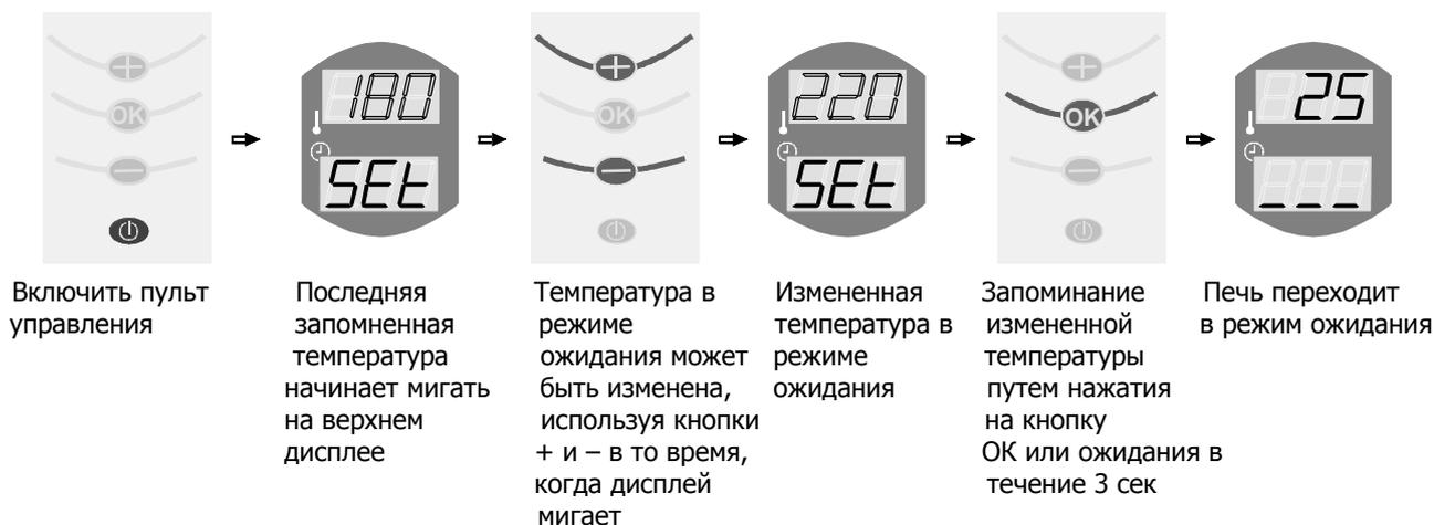
Когда печь находится в режиме ожидания нижний красный дисплей показывает с помощью линий насколько заданная температура приближается к установленной. Верхний дисплей показывает температуру отсека для камней в настоящий момент. Когда заданная температура достигается, загораются все три линии.
