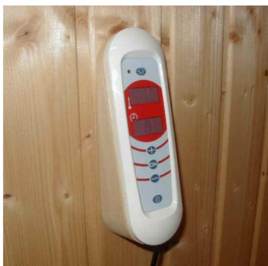
Накладка снимается путем одновременного нажатия маленькой отверткой или другим подходящим предметом на клипсы и затем осторожного снятия наклейки.
