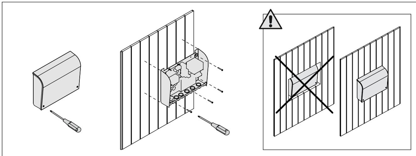
Figura 4. Apertura del coperchio dell'unità di alimentazione e montaggio dell'unità alla parete
