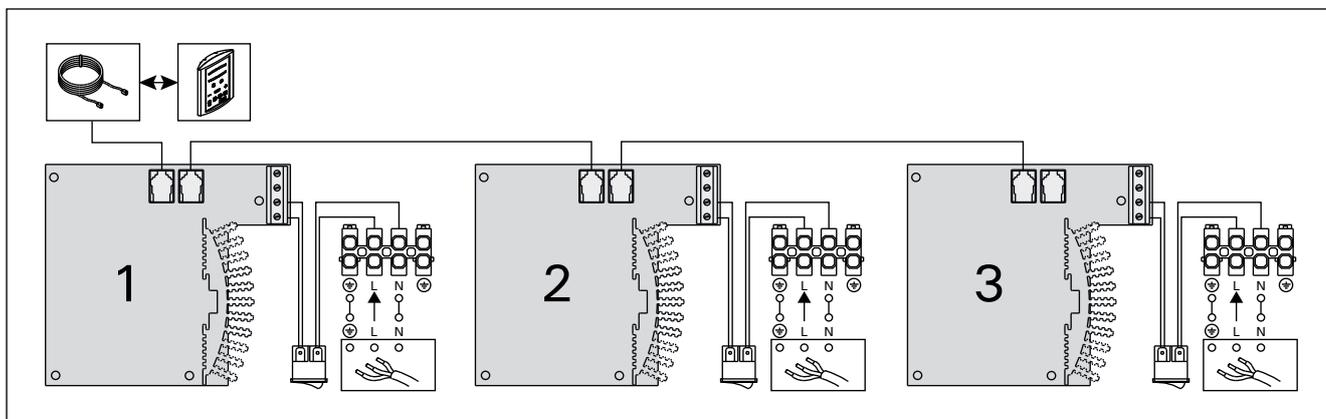
Figura 6. Collegamento in serie delle unità di alimentazione
